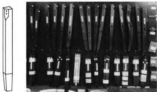
图6 利用次小薪材制造的家具腿部件
